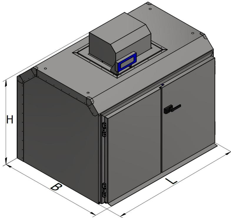
**Kühlzelle/ Kühlkammer Typ-KK1 > Isoliertes Gehäuse, Kammer-Innenraum kompl. verschweißt, Doppeltür ohne Mittelholm mit Umlaufender Dichtung. Türflügel steigend, einseitig mit Verschluss und Schließzylinder, aufgesetztes Kompakt-Aggregat für NK-Kühlung.**
