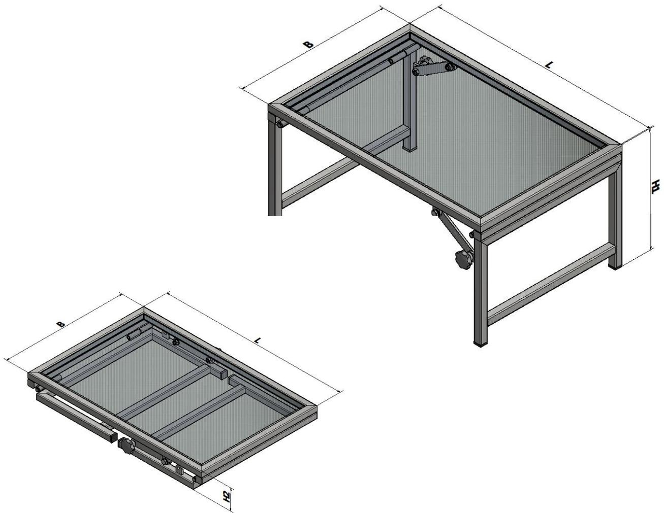
**Tisch TS-600x400 >Tischplatte aus Lochblechprofil 5x5, FüÙe einklappbar über Diagonallaschen und Sterngriffschrauben gesichert, Fußenden mit Kunststoff-Schutzkappen.**
