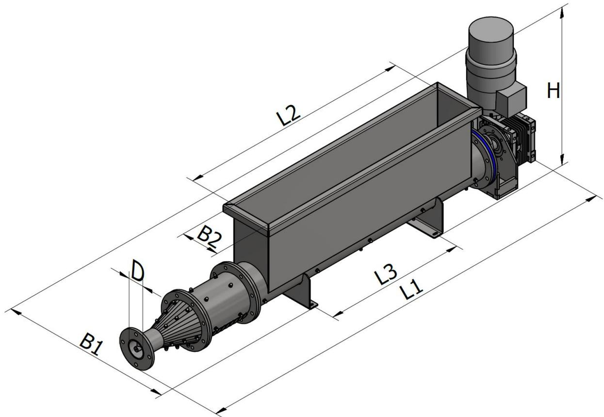
**Pressschnecke/Entwässerungsschnecke PS-160 > Rohrschnecke mit Beschickungstrichter, Auslauf-Adapter mit Spaltsiebeinsatz, Konus/ Reduzieradapter mit Erweiterungsflansch, Antrieb > Elektro-Getriebemotor, Abdichtung Stopfbuchse einstellbar, Schneckensteigung 70 mm**
